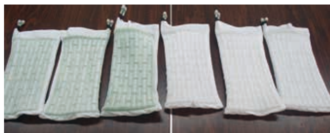
伊藤社長が開発した内部に流体回路を自由に成形できる布帛という新技術
